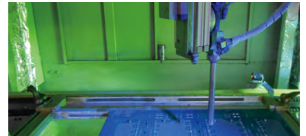
PCBA喷涂后蓝光检测
